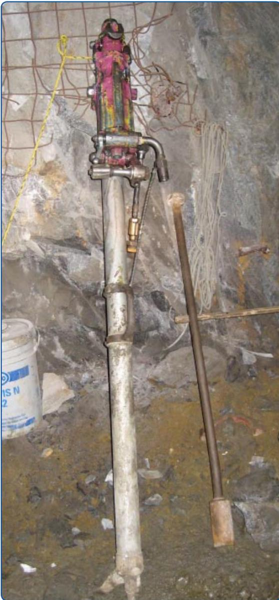
Figure 1 : Foreuse sur béquille utilisée pour installer une plateforme pour le racleur.
