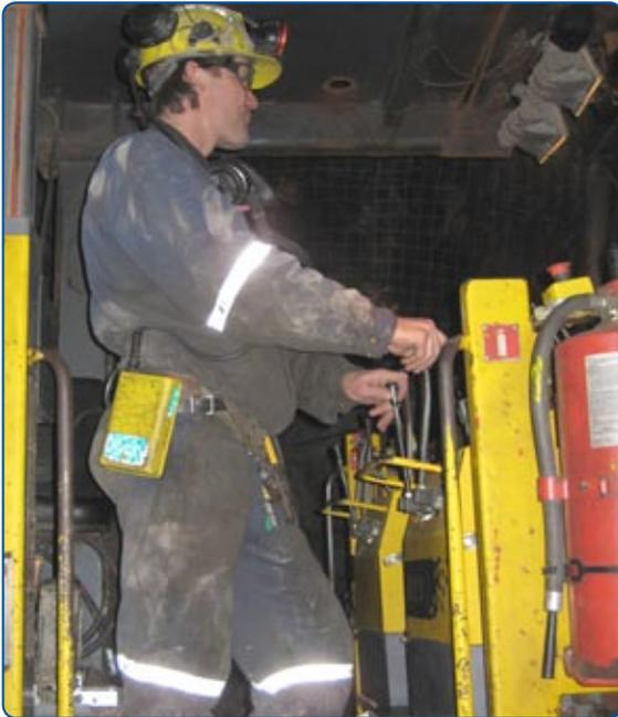
Figure 1 : Utilisation des commandes du jumbo
