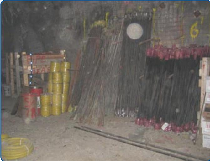
Figure 1 : Boulons utilisés pour le soutènement
