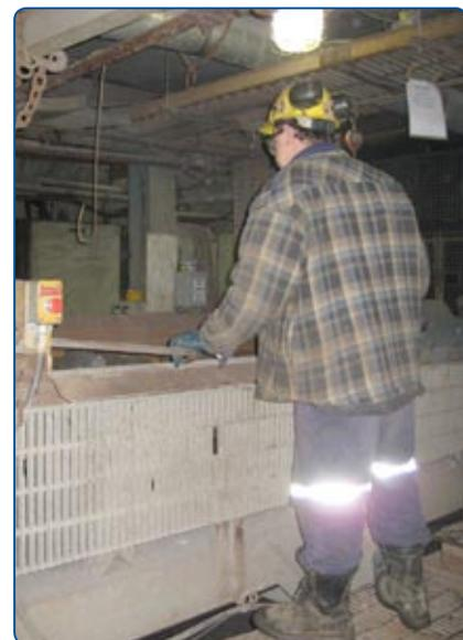
Figure 4 : Opérateur de skip qui surveille le convoyeur
