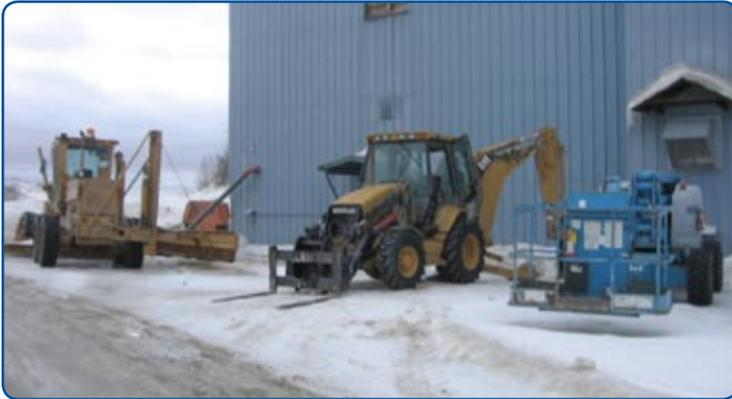
Figure 1 : Niveleuse, pelle rétrocaveuse, nacelle élévatrice
