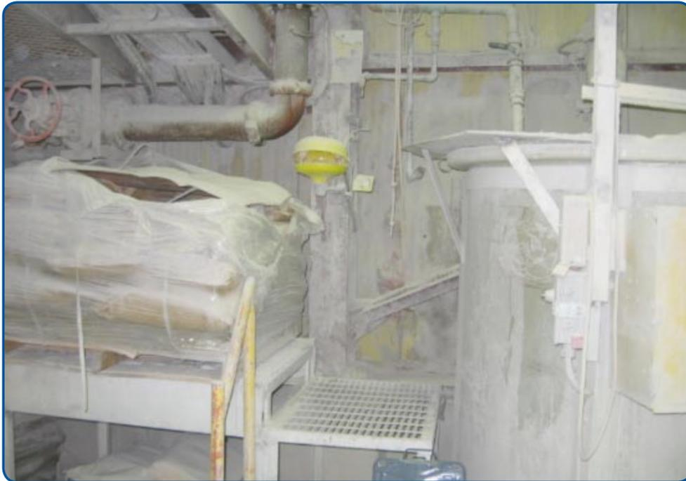
Figure 1 : Réactif sec sur une palette (gauche) à placer dans une trémie (droite).
