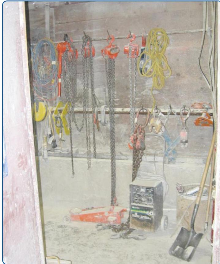
Figure 1 : Palans à chaîne, vérins, monte-charges, cordes, poulies
